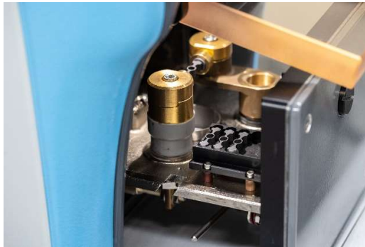
Abbildung 14: Einrichten der Tiegelofenheizplatte
