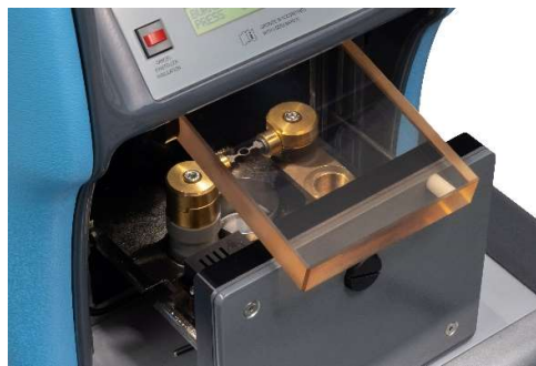
Abbildung 10: Generator mit geöffnetem Schubfach
