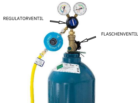
Abbildung 9: Kontrolle des Argon-Flusses
