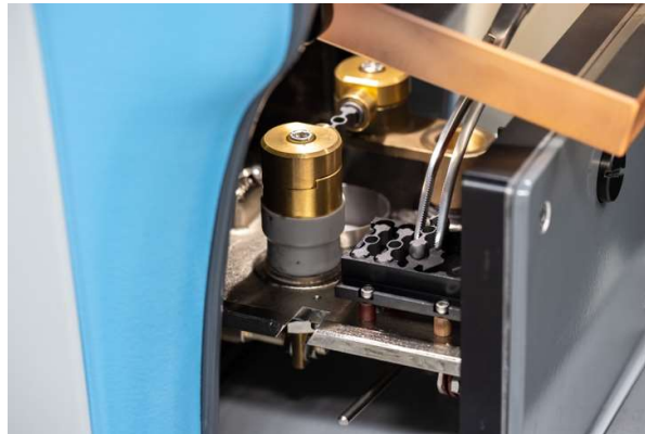
Abbildung 15: Beladen der Tiegelofenheizplatte
