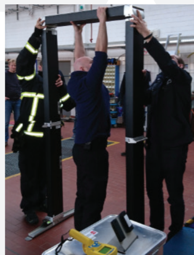
Einfacher Aufbau des Portal-M mittel Steck- und Klemmsystemen.
